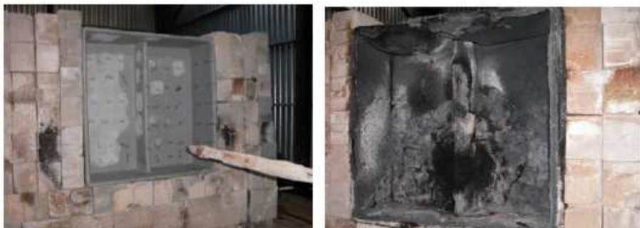
Immagine1 – Prova di resistenza al jet fire 6 di un sistema di protezione costituito da una scatola di acciaio con rivestimento protettivo
